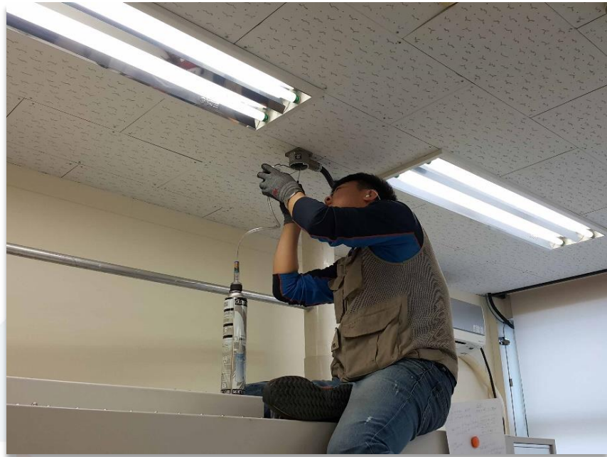
Span Gas 주입 - 응답시간 측정
